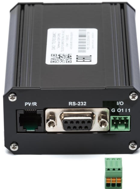
Рис. 2: Разъём основного интерфейса WRX700/900-R4 (RS-232)
