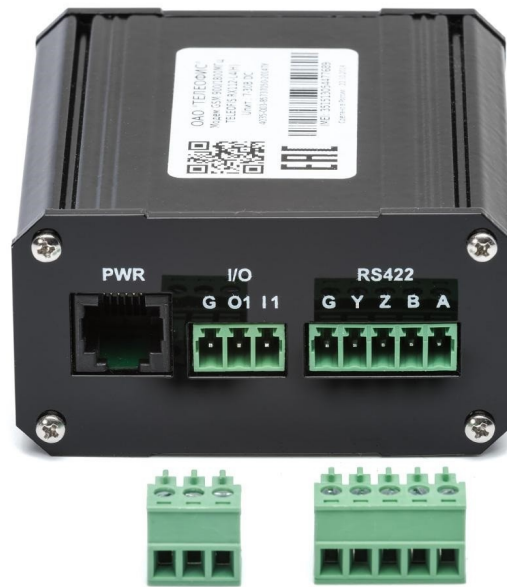
Рис. 4. Внешние разъемы терминала с интерфейсом RS-422.
