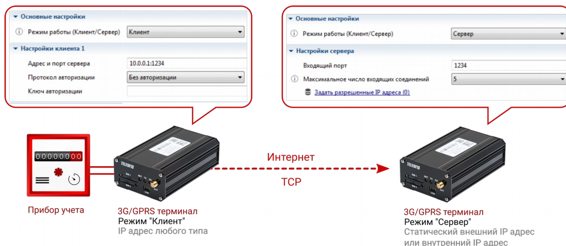
Рис. 11. Схема подключения WRX «Клиент» - WRX «Сервер».
